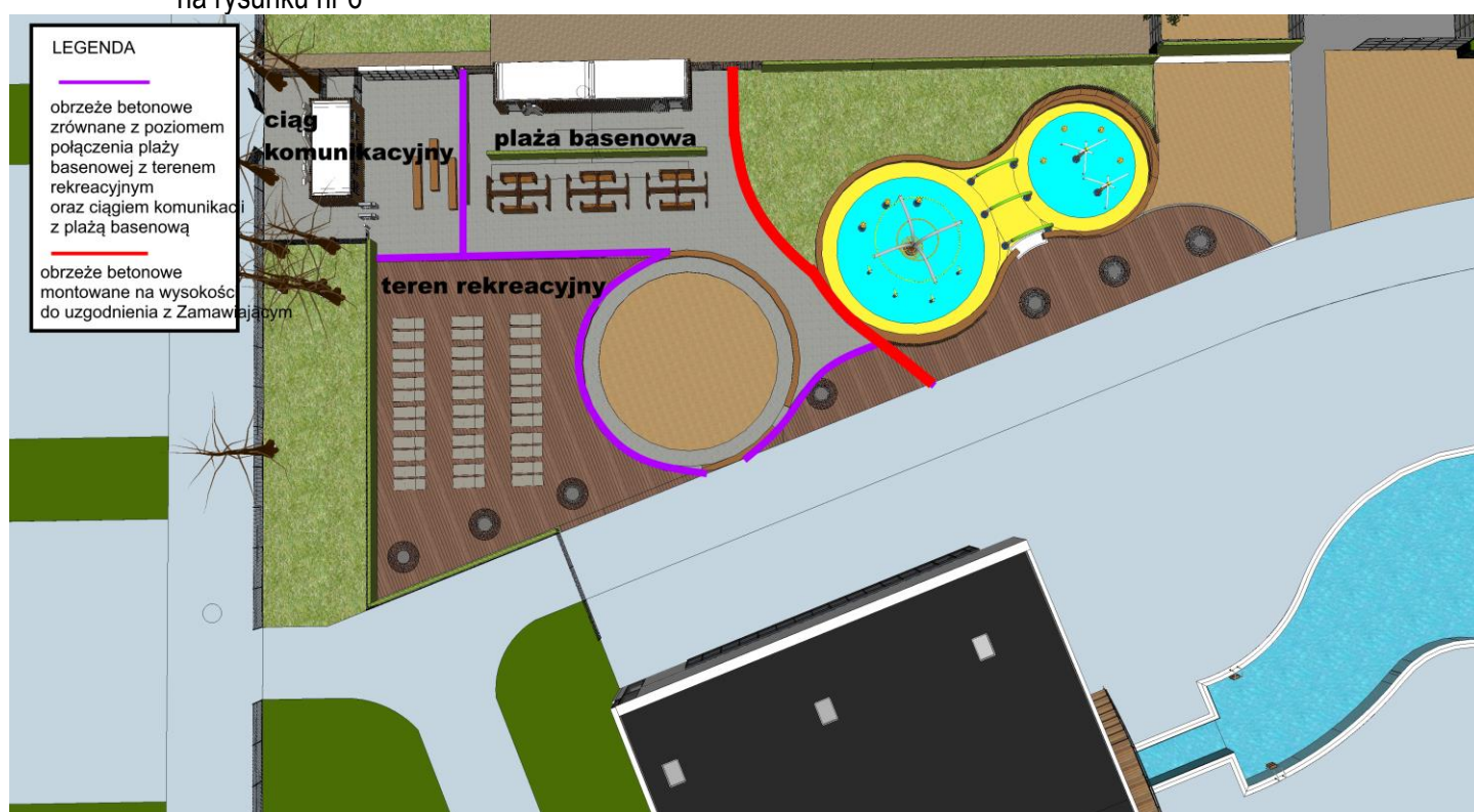
Rysunek 6 - montaż obrzeży betonowych na nowo projektowanych ciągach komunikacyjnych, plaży basenowej, terenu rekreacyjnego
